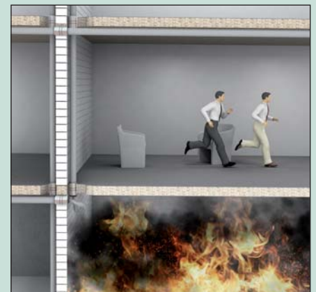
3. Le BIS Pacifyre® MK II Manchon coupe-feu entre en action et les personnes ont le temps d'évacuer
