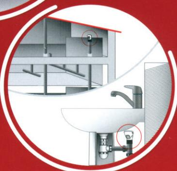
Nicoll innove dans la conception de son nouveau Clapet Equilibreur de Pression (anciennement appelé aérateur à membrane). Il permet d'éviter le désamorçage des siphons, de supprimer les gargouillis, les remontées d'odeurs et d'améliorer l'écoulement dans le réseau d'évacuation.
