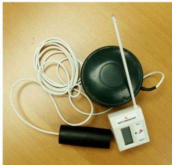
La jauge est déjà configurée à l'usine. Il suffit donc de mettre le display dans une prise électrique.
