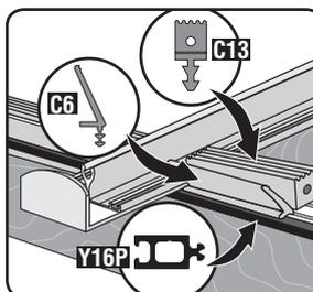
6. Fixez le joint d'étanchéité (C6). En cas de double vitrage, le joint C6 est serré par le Y16P contre le fraisage. Le joint de support C13 est fixé dans la rainure.
