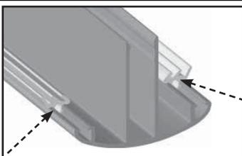
5. Fixez le joint C8 dans le CL16/32 et le CLL. Laissez 25 mm libre en bas pour le profilé d'obturation. Posez les clips CL16/32.
