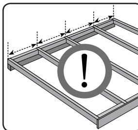
2. Déterminez les distances entre-axes entre les porteurs en fonction du vitrage et de la série souhaitée (voir à la page 4). Pour du vitrage, respectez les consignes du fabricant de vitrage.
