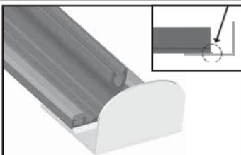
5. Placez l'arrêt S16C aux extrémités de tous les profilés porteurs (T16.2) jusqu'à la petite cale et vissez l'arrêt.
