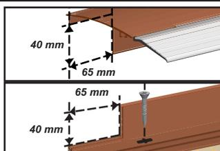
2. Enlevez 65 mm (gauche & droite) de la partie verticale des profilés mureaux MP et CLM. Vissez le MP sur le chevron avec vis à tête noyée. Glissez le joint C1CX dans le CLM.
