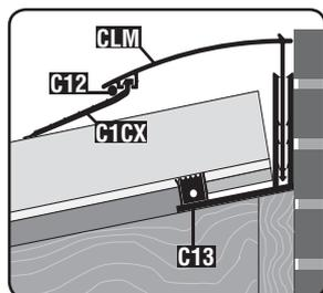
9. Fixez le joint C12 entre le clips mural CLM et le joint C1CX pour renforcer la pression sur les plaques.
