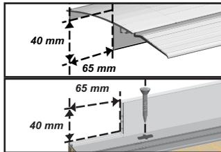
2. Enlevez 65 mm (gauche & droite) de la partie verticale des profilés mureaux MP et CLM. Vissez le MP sur le chevron avec vis à tête noyée. Glissez le joint C1CX dans le CLM.
