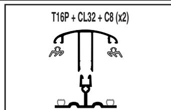
8. Pour des applications avec des plaques de 25 /32 mm, il faut utiliser le clips CL32 (voir à la page 10).
