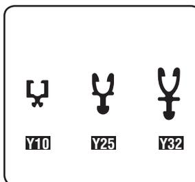
10. En fonction des épaisseurs de vitrage, les profilés d'adaptation Y10/Y25/Y32 se mettent dans les porteurs. Voir le tableau à la page 10.
