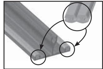
4. Placez les joints de support C3 dans les profilés porteurs et latéraux. Les joints sont fabriqués en double et il faut les séparer avant de les placer.
