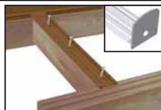
3. Posez les profilés TPH et TPHL jusque contre le profilé MP et vissez-les tous les 50 cm sur les porteurs en bois. Vissez l'arrêt S38.3 au côté perforé des porteurs de vitrage TPG & TPGL.
