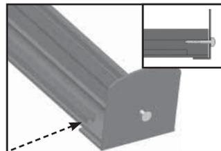
3. Découpez 25 mm du joint coex en bas du T16P et LP. Vissez l'arrêt S16.3/S32.3 avec vis RVS.
