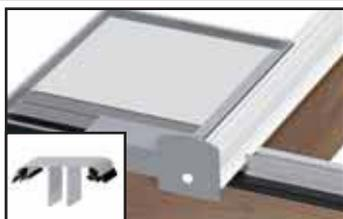
6. Installez le vitrage et collez le L432 sur le côté frontal du vitrage. Fixez les joints C8 dans les clips à serrage CLSB. Le profilé Y10/Y25 peut être utilisé en fonction de l'épaisseur de vitrage.
