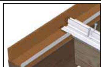
4. Adaptez les porteurs de vitrage TPG et TPGL à la longueur désirée et glissez-les dans les profilés en aluminium jusque contre le profilé mural MP. Bloquez-le uniquement en haut avec 2 vis. Fixez le joint C13 dans le profilé MP.
