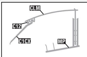
7. Installez le joint C12 rond entre les clips mural CLM et le joint C1CX pour augmenter la pression sur les plaques.
