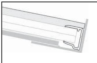
7. Le joint C2CX assure l'étanchéité des plaques. Poussez le joint C2CX le plus haut possible avant de le découper un peu plus long que le S16C. En haut, le joint C4CX recouvre le joint C2CX.
