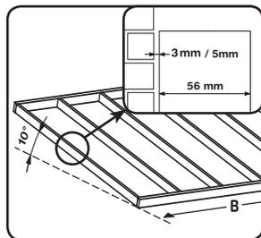
1. Implants une structure portante en bois sous un angle de 10° (174mm/m). Si la construction se fait de manière latérale contre un mur, il faut prévoir un jeu de 3 mm. Pour des applications avec du vitrage, il faut prévoir un jeu de 5 mm.
