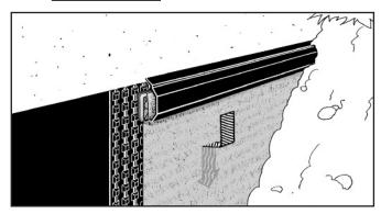
**Platon Double Drain**™ filtre et draine l'eau du sol. La natte filtrante crée la lame d'air et de drainage devant le mur de fondation et filtre les eaux de percolation. Grâce à la natte filtrante, la terre est séparée de la couche drainante.
