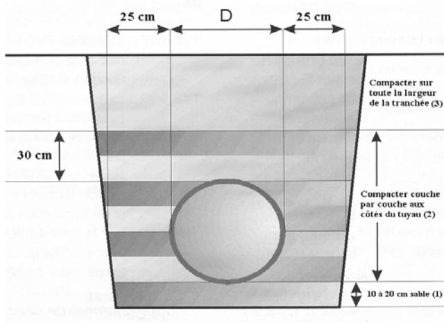
La terre de remblai, sable de rivière ou sable de carrière, est posée en couches à côté du tuyau et est compactée jusqu'à ce que plus aucun changement de volume ne se produise. Sur une hauteur de 30 cm au-dessus du tuyau, la terre de remblai n'est compactée que sur les deux côtés du tuyau (et pas directement au-dessus du tuyau) (2). Au-dessus de cette hauteur, la tranchée peut être comblée avec de la terre ordinaire et compactée sur toute la largeur (3).
