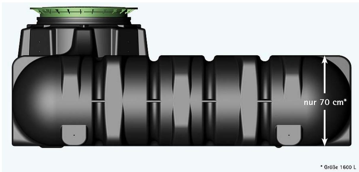
Les dimensions de la cuve Platine® parlent d'elles-mêmes : la cuve 1500 L ne mesure que 210 x 120 cm, pour une hauteur hors dôme de 70 cm. La hauteur d'enfouissement réduite de la cuve permet une fouille minimale. Grâce au faible poids de la cuve Platine, il suffit de deux personnes et d'une demi-journée seulement pour installer la cuve.
